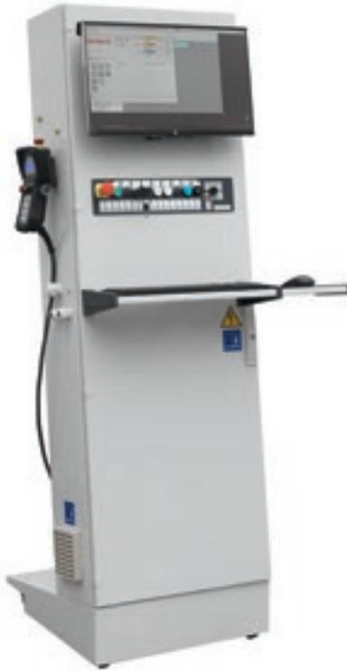
Мобильная консоль с сенсорным монитором. Графический современный и интуитивный интерфейс для удобного управления станком.
